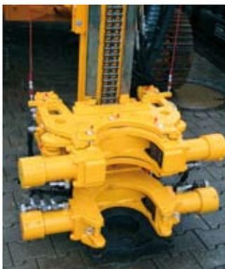
Klemm- und Brechvorrichtung Typ D
