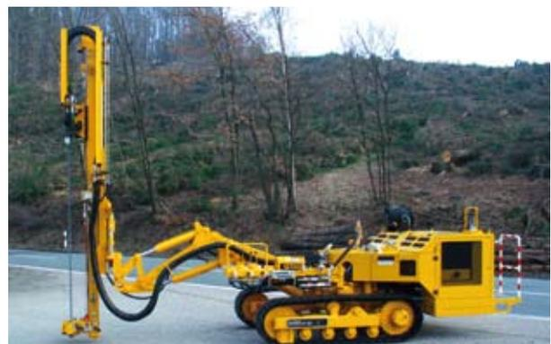
Bohrgerät KR 802-3K (erhöhte Reichweite durch Sondervorbau)
